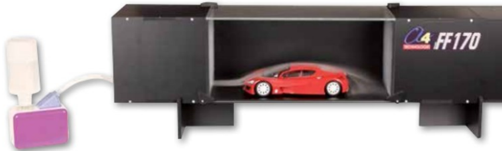
Maquette de véhicule à l'échelle 1/20 ème dans une soufflerie pour vérifier l'aérodynamisme
