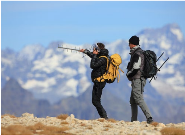
↑ Suivi télémétrique des lagopèdes équipés d'une balise GPS couplée à un émetteur radio : le signal est capté par l'antenne.
