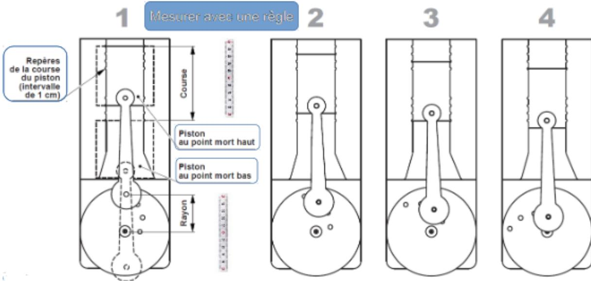
Compléter les cotes dans le tableau ci-dessous (Mesurer les rayons et la course du piston avec une règle)
